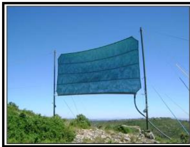
Figura 41. Esquema de un captador de niebla plano (Estrela et al. , 2008).
