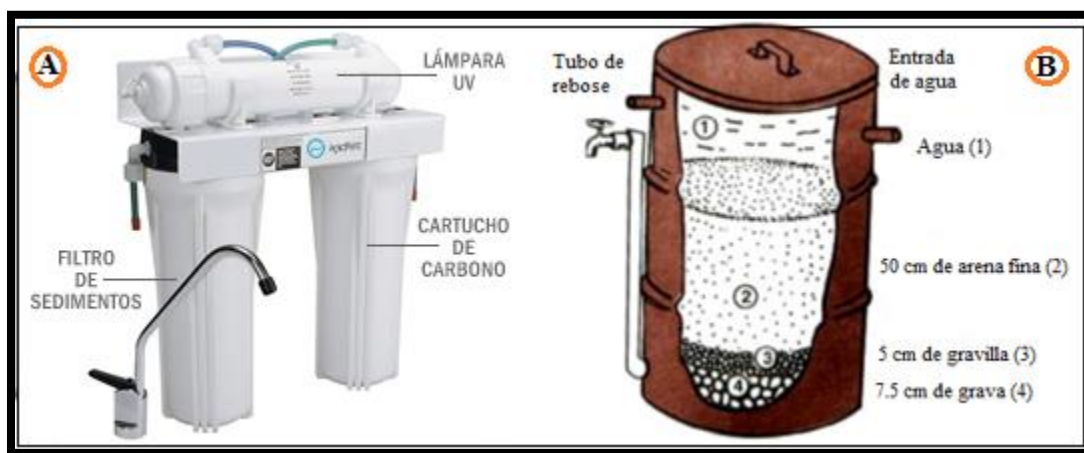
Figura 38. Filtro prefabricado (A) 8 y filtro lento de arena casero (B).
