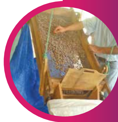
Figura 26. Selección de granos por tamaño empleando zarandas
