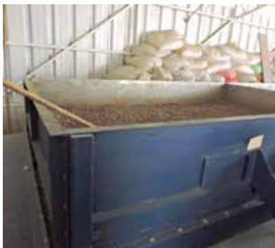
Figura 25. Secador artificial de cacao tipo Samoa
