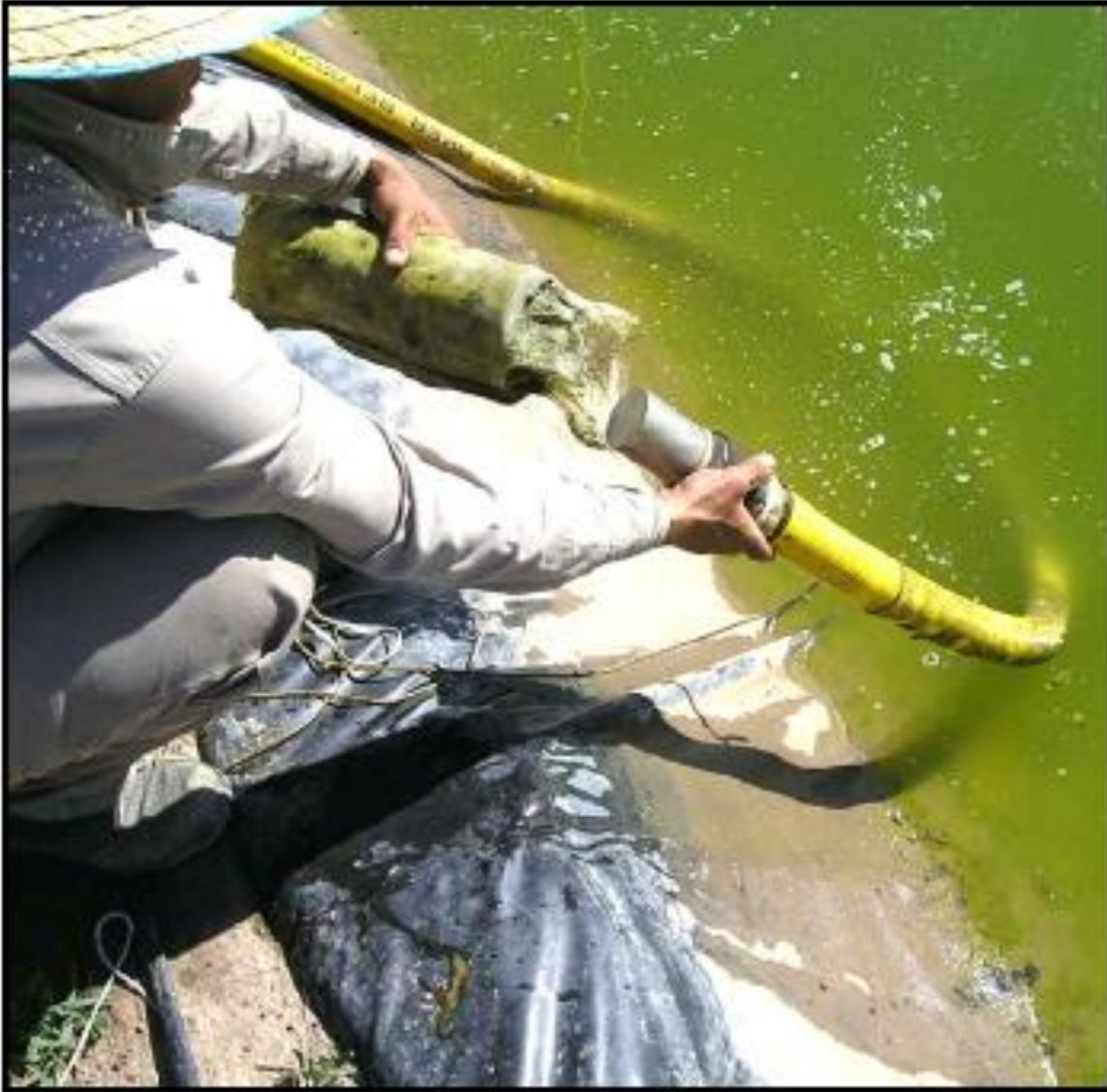
Pre-filtrado en la tubería de succión
