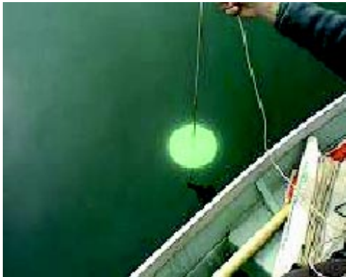
Figura 9. Forma de medir turbidez del agua usando un disco Secchi
