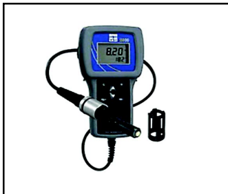
Figura 7. Medidor de oxígeno de la marca YSI de uso común en granjas camaroneras
